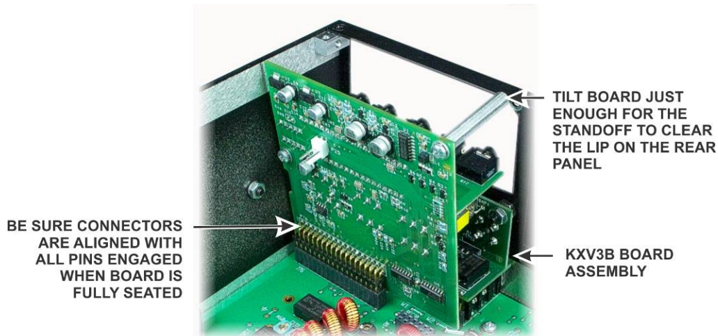
Figure 14. Installing KIO3/KIO3A Main Board.
